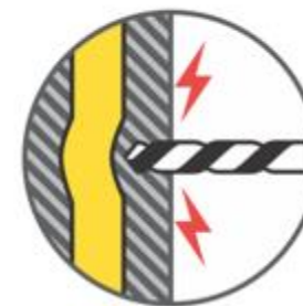
Механическое повреждение изоляции
